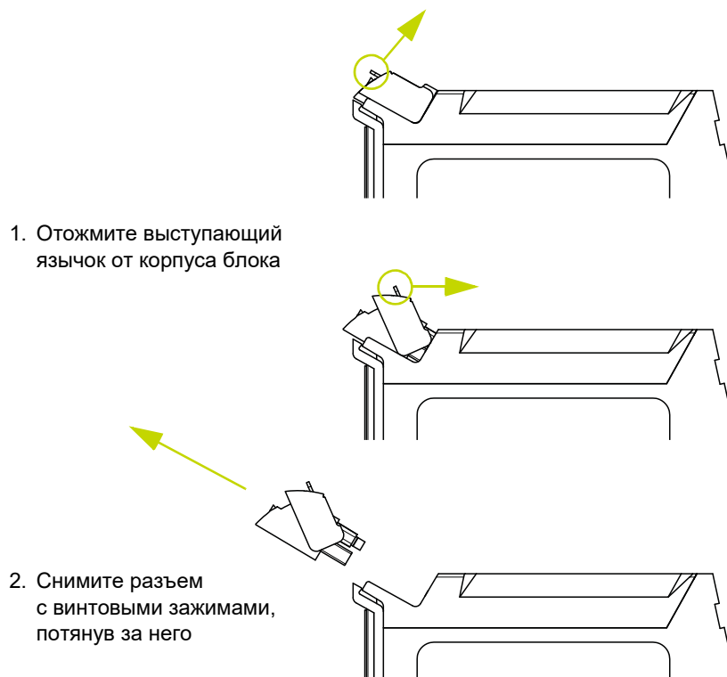
Рис. 5-2. Снятие разъема с винтовыми зажимами с корпуса блока GSI127
